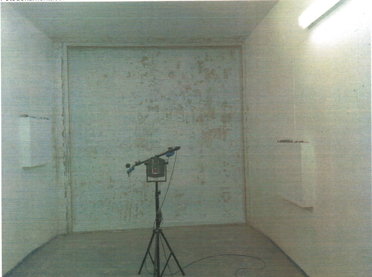
Obr. č. 1 – laboratorní měření vzduchové neprůzvučnosti stěny
